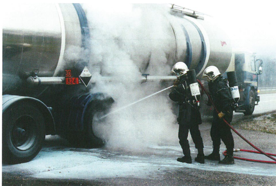
Feu du système de freinage sur un camion transportant une matière dangereuse.
