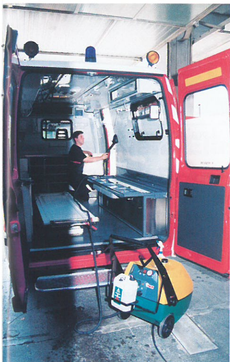
Désinfection d'un VSAB à l'aide de l'appareil à vapeur
