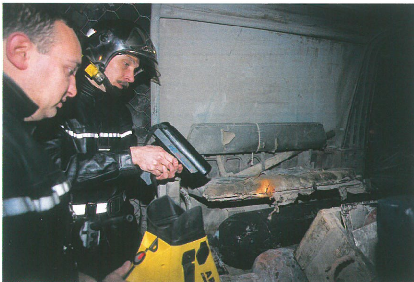
Mesure de température par caméra thermique et thermomètre infrarouge sur le corps de la bouteille
