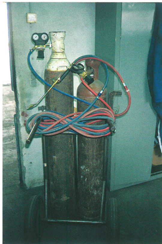
Chalumeau oxyacétylénique composé d'une bouteille d'oxygène et d'une d'acétylène.
